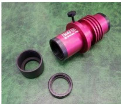
同焦点アイピースをお作りになる場合は、付属の同焦点リングとプラスチックネジを利用して任意の位置に固定してください。付属の 31.7mm ノーズピースは 2 種類あり、短い方は先端が C マウントネジになっています。長い方は延長スリーブの役割と先端に 31.7mm 枠付フィルターが装着できるようになっております。(ネジ径 : M28.5mm)
