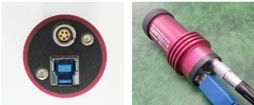
背面の USB3.0 コネクタに USB3.0 ケーブルを、円形の ガイドポートに専用ガイドケーブルを装着します。 ガイドケーブルは赤い印を 合わせて装着してください。
