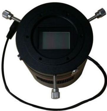
ヒーターリングの開口部を QHY11 のチップ形状と合わせて接続します。ヒーター使用時は DC 分岐ケーブルにて電源を供給してください。
