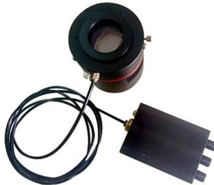
図のようにヒーターリングのドライチューブ挿入口に接続金具をネジこんで、エアープンプのチューブを接続します。
