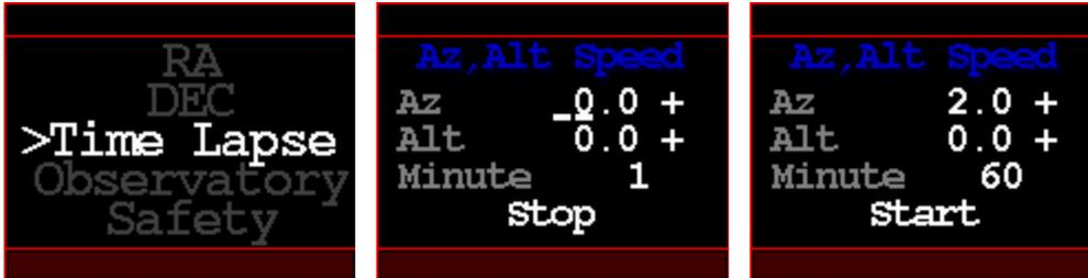
“Az(赤経軸)”及び“Alt(赤緯軸)”で設定した角度を“Minute(分)”間駆動します。Start/Stop は上下ボタンで変更可。Start を選択すると駆動が開始します。設定した時間に達すると自動的に駆動停止します。
