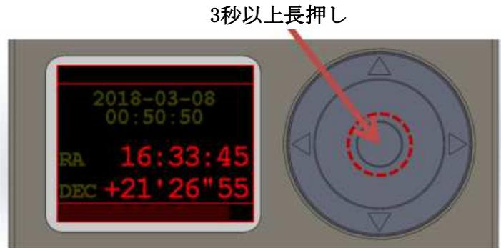
メニュー画面表示時トラッキングは継続しますが、方向キーによる東西南北の操作はできなくなりますので、駆動操作を行う場合は項目aの望遠鏡操作画面に戻ってから行ってください。
