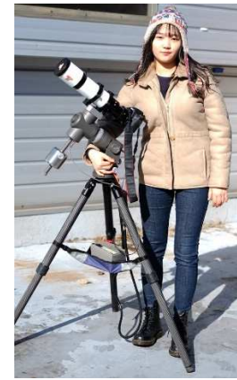
9. おおよそのバランス調整しましょう。従来のクランプ式の赤道儀と異なってバランスを厳密に合わせる必要はありませんが、下記の「バランス調整について」をご参考ください。
