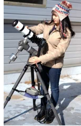
9. おおよそのバランス調整しましょう。従来のクランプ式の赤道儀と異なってバランスを厳密に合わせる必要はありませんが、下記の「バランス調整について」をご参考ください。
